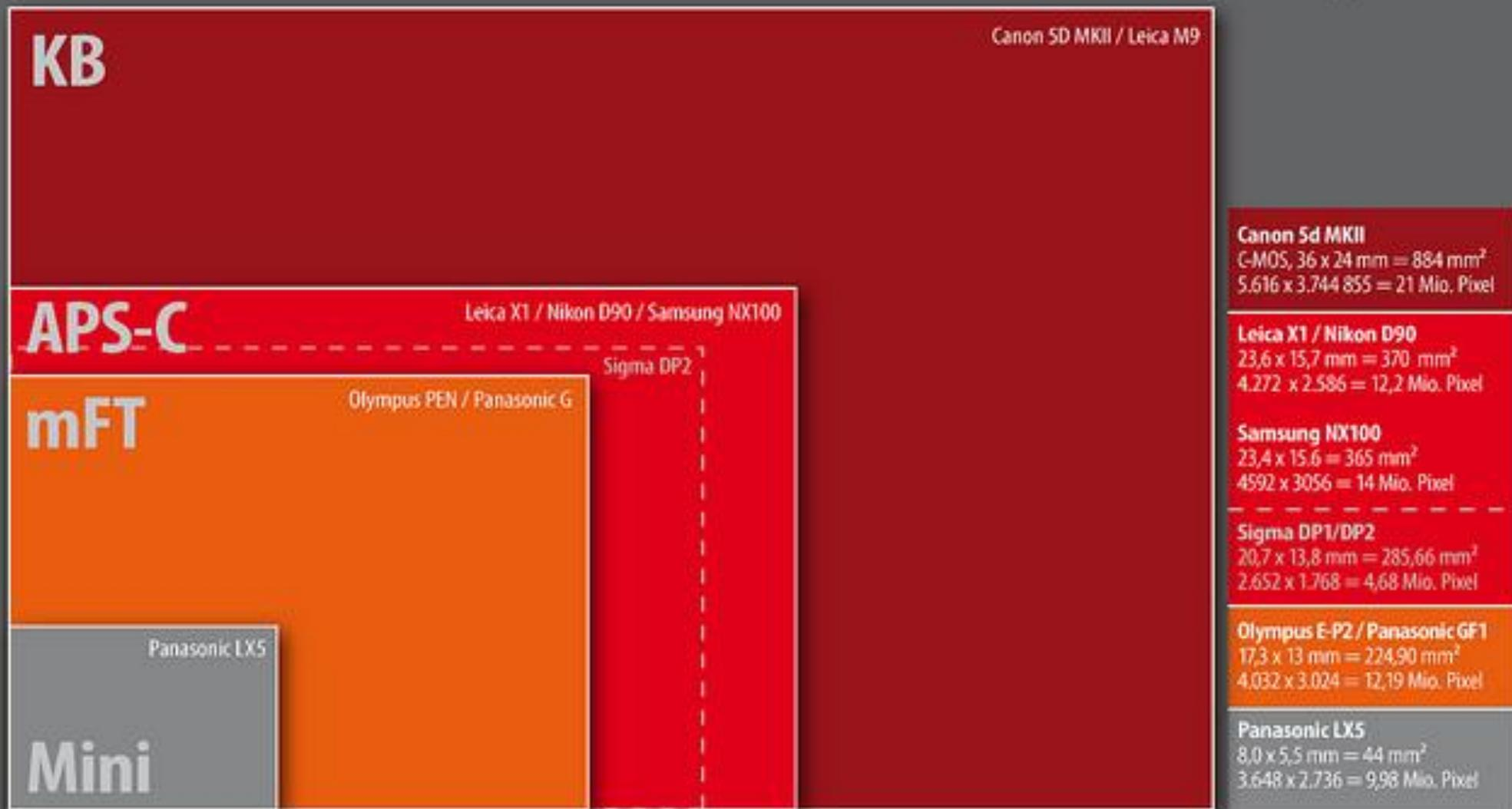
Come vedete dallo schema sopra riportato, il sensore di una compatta è molto più piccolo di quello di una reflex Full Frame e capirete quindi che mettere **15** megapixels sul sensore di una compatta è diverso da metterli su quello di una reflex. Su un sensore più grosso, a parità di risoluzione, i pixels sono più grossi e distanziati tra loro e questo si traduce in una resa migliore sotto tutti i punti di vista.
